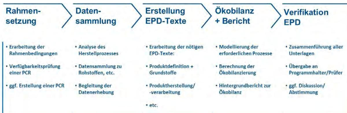
Abb. 10: Grundlegende Inhalte und Basisschritte der Erstellung einer EPD
